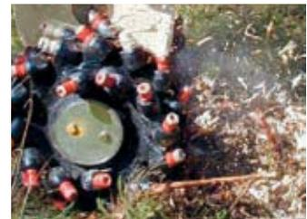
Die optimale Konfiguration und Auswahl der Meißel garantiert eine hohe Löseleistung und einen niedrigen Meißelverschleiß. Unsere Hydraulik-Bagger-Anbaufräsen sind für eine optimale Materialzerkleinerung bei ruhigem Fräsenlauf, geringer Vibration und geräteschonendem Einsatz konstruiert.
